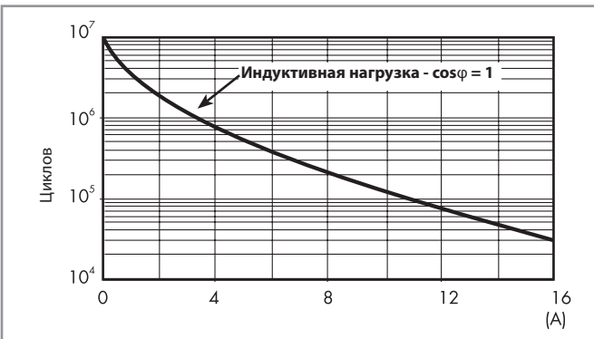
F 45 - Электрическая долговечность (АС) при ном. нагрузке тип 45.31/45.91
